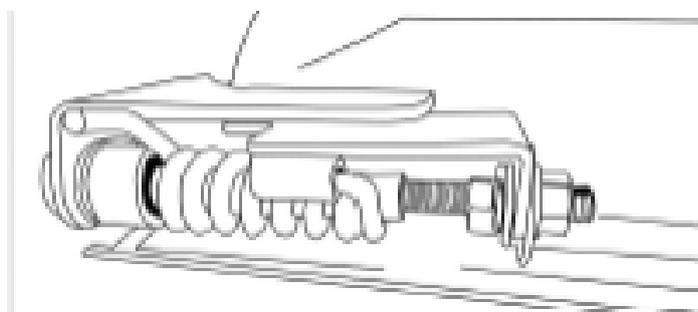
6.4 Die Mutter (L) mit dem Schraubenschlüssel Nr. 14 (M) anziehen, während die Mutter (E) mit Schraubenschlüssel Nr. 14 (N) gegen gehalten wird
