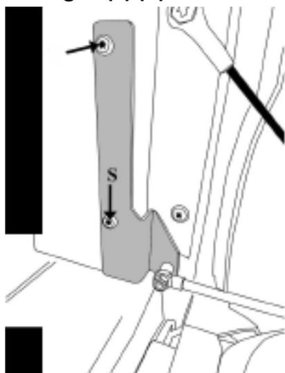
9. Befestigen Sie den Dämpfer an der Heckklappe, indem Sie die Dämpferhalterung (T) unter der Heckklappenschlaufe anbringen (U) und zusammen mit der Originalhalterung festziehen (V) (W)
