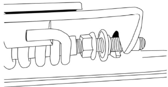
6.1 Setzen Sie die Feder, wie im Bild oben dargestellt, in die Heckklappenhalterung ein
