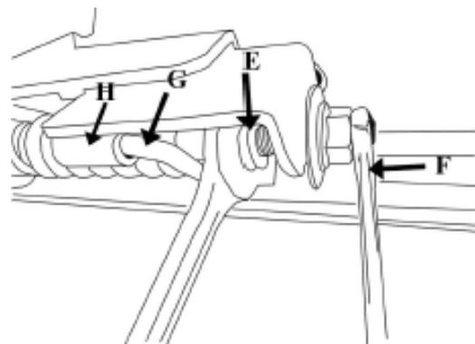
Stellen Sie sicher, dass das Federende (G) in die Führung (H) der Heckklappenhalterung eingesetzt ist
