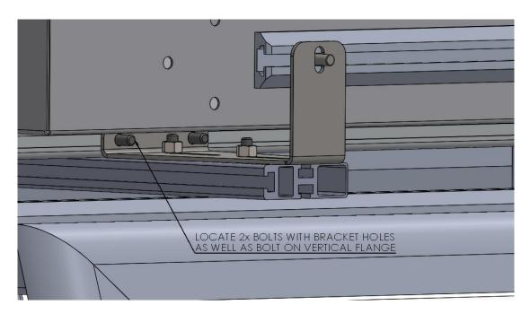
TYPICAL ARRANGEMENT ON 4 ENDS OF LOAD BARS.
