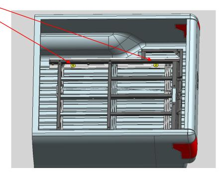
Montieren Sie die Schublade nun wieder mit der Schiebeplattform, gemäß den Arbeitsschritten zum Lösen. Überprüfen Sie, dass alle Schrauben fest angezogen sind, die Schublade sich problemlos schieben lässt und die Heckklappe im eingefahrenen Zustand geschlossen werden kann. Fertig!!
