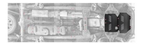
Schieben Sie nun den 2. Teil des Unterfahrschutzes, mit den Langlöchern, über die hinteren Befestigungsschrauben des 1. Teils. Ziehen Sie diese Schrauben nun fest an. Teil 3 des Unterfahrschutzes verfügt über keine Langlöcher und wird zusammen mit Teil 2 an den hinteren Befestigungspunkten montiert.
