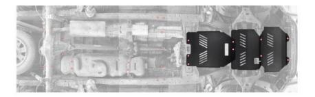
Befestigen Sie Teil 3 des Unterfahrschutzes zusammen mit Teil 2. Ziehen Sie die Schrauben fest an. Für die beiden neben einander liegenden hinteren Befestigungspunkte sind Aufnahmen mit Gewinde vorhanden.
