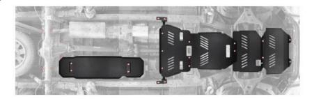
Lösen Sie die beiden Halterungen des Tanks. Stützen Sie diesen z.B. mit einem Wagenheber oder ähnliches ab. Führen Sie die beiden Befestigungbleche mit Gewindebolzen durch die originale Halterung. Befestigen Sie nun den Tankschutz und ziehen Sie alle Schrauben fest an.
