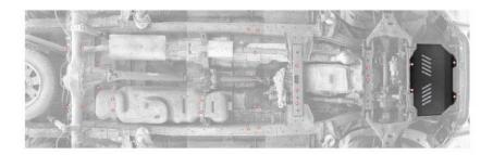
Entfernen Sie den orginalen Unterfahrschutz. Lösen Sie die markierten Schrauben. Dies sind gleichzeitig die Befestigungspunkte für den neuen Unterfahrschutz. Ziehen Sie die hinteren Befestigungsschrauben nur handfest an. Mit diesen befestigen Sie ebenfalls Teil 2 des Unterfahrschutzes.
